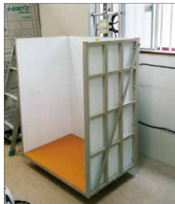
■箱型台車 B H1125×W900×D625 前面から積み降ろし用 箱型台車
