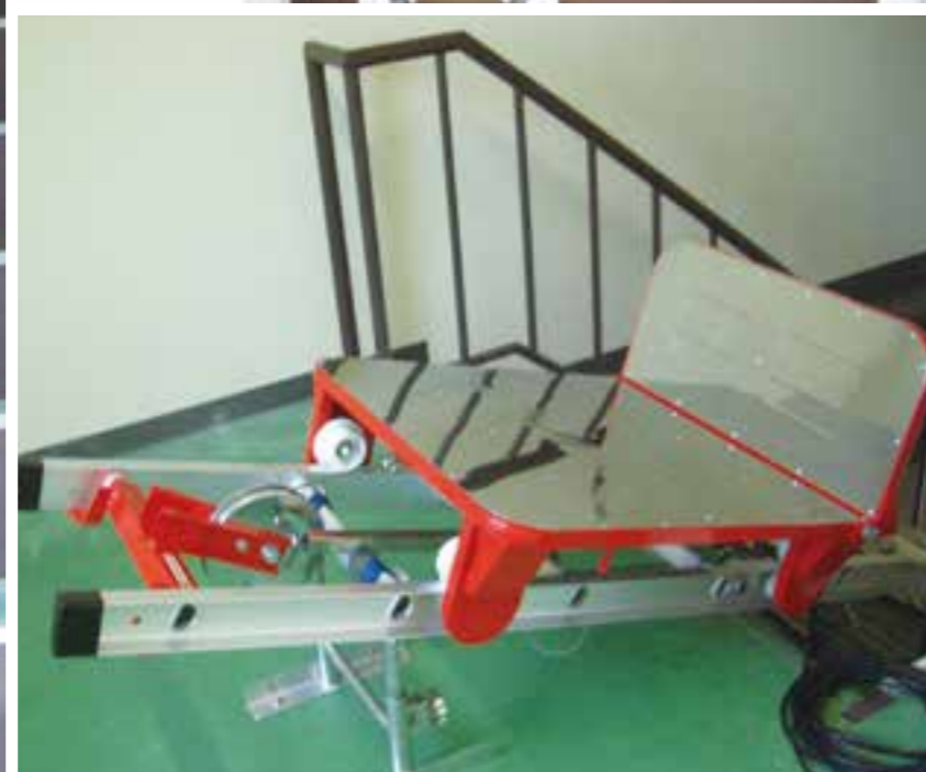
中間曲りレールを使用し角度調整
