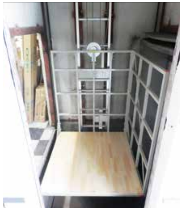
■落下防止装置付き台車 H1200×W1000×D1000 L型台車 ワイヤーロープの切断時に台車の落下を防止する落下防止装置付
